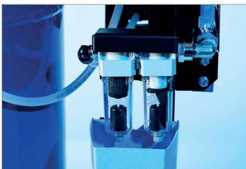
Les compresseurs à huile ne conviennent pas à un usage en cabinet dentaire: en effet, la moindre trace d'huile dans l'air comprimé peut exercer une influence négative sur la solidité des matériaux appliqués sur la dent. En outre, l'huile de lubrification génère des dépôts dans les conduits d'acheminement d'air. Ceux-ci impliquent une perte de puissance et un vieillissement prématuré des compresseurs et instruments fonctionnant à l'air comprimé.
